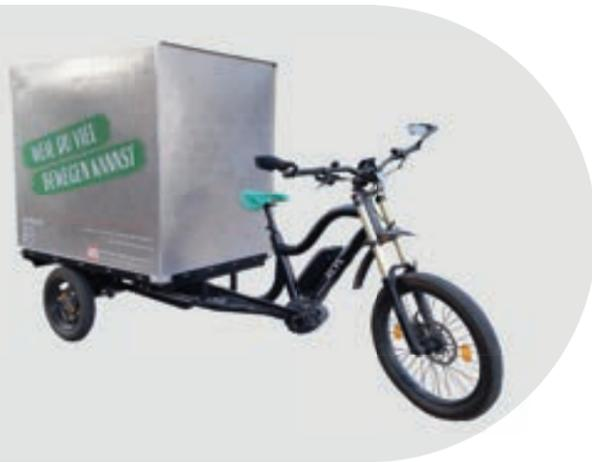
Mit dem Pickup Work 2.0 lassen sich sperrige und schwere Gegenstände klimafreundlich und nahezu mühelos transportieren. Die Ladefläche des Pickup Work erfüllt die Norm für Europaletten, so dass es sich mittels Hubwagen oder Gabelstapler einfach beladen lässt. Der Transportkoffer hat einen Korpus aus strukturiertem Aluminium (Schutzklasse IP 53) und eine abschließbare Doppeltür. Dadurch eignet sich dieses Schwerlastenrad bestens zum Einsatz für gewerbliche Zwecke.
