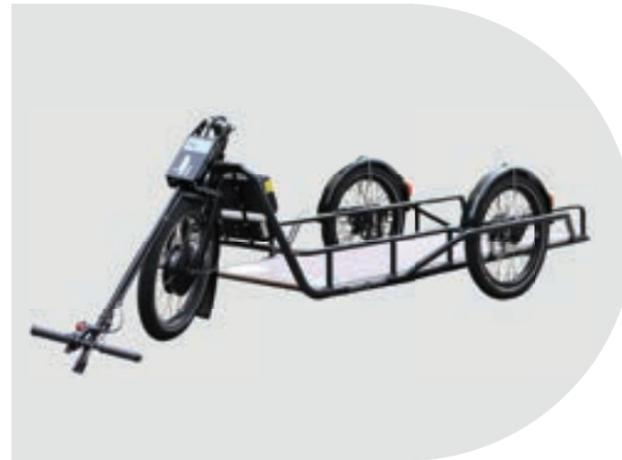
Der elektrisch unterstützte Lastenfahrradanhänger eCarla von Carla Cargo ermöglicht flexible, sichere und klimafreundliche Bewegung im Stadtverkehr. Seine großzügige Ladefläche bietet viel Platz zum Transport von großen und schweren Gegenständen. Der eCarla ist stabil verarbeitet und verfügt über eine mechanische Auflaufbremse und eine mechanische Handbremse mit Feststellfunktion.
